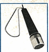
N 8302 Dynam. Breitband-Mikrofon Richtcharakteristik: Niere, Empfindlichkeit 0,24 mV/ \mu bar, Impedanz 500 Ohm, Stativgewinde \frac{9}{16} ". DM 83,-*)
